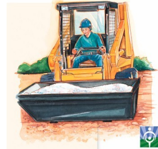
Figura 6.1.a. Los Tractores Cargadores Pequeños son controlados con palancas de mano o controles manuales. Empuje la palanca hacia adelante y se mueve hacia adelante, mueva la palanca para atrás y vaya en reversa. Suelte la palanca y se detiene. Estas palancas también dirigen la máquina.
