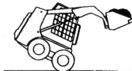
Figura 6.1.c. Los tractores de carga se pueden volcar hacia el frente si se sobrecargan. Esta es una razón muy importante de por qué se debe utilizar el cinturón de seguridad, también entender las limitaciones de carga del cargador.
