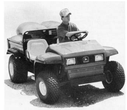
Figura 6.2.c. Un vehículo de servicio es versátil. Puede hacer los trabajos pequeños que un camión de carga no puede hacer adecuadamente. Recuerde que el vehículo de servicio tiene sus limitaciones. Sobrecargar, mover cargas y parar muy rápido, puede causar vuelcos.
