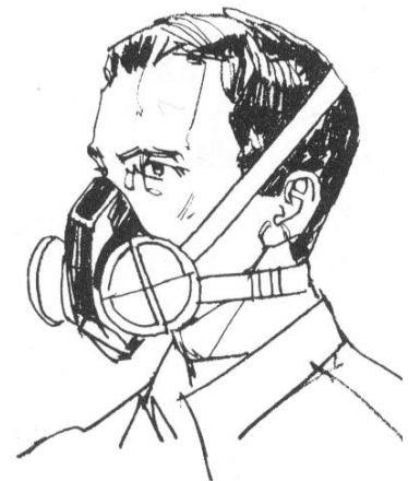
Figura 3.3.1.d. La máscara para respirar con cartucho químico, tiene un filtro reemplazable para atrapar polvo y partículas grandes. Estos respiradores no proveen oxígeno. Estos respiradores no filtran polvo tóxico ni vapor de materiales.
