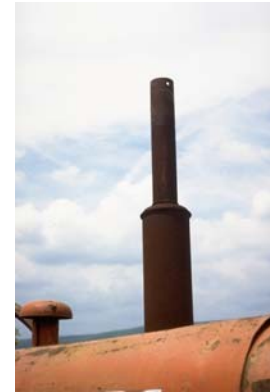
Figura 3.2.a. Una chimenea que se usa para liberar gases, o una mufla dañada puede incrementar los niveles de sonido del motor. La condición de las muflas deben de ser parte de una revisión técnica de seguridad.
