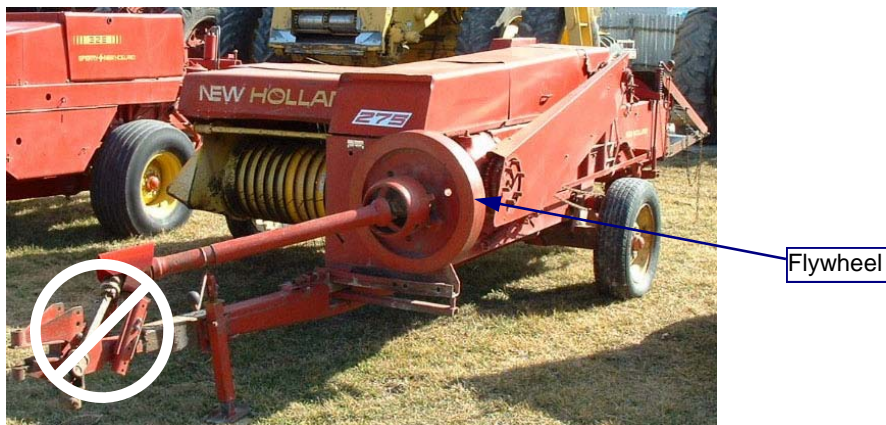
Figura 3.1.d. El volante de una empacadora de pacas de heno es un ejemplo de una pieza libre de movimiento. El volante hace que la empacadora corra normalmente, cuando se recoge una buena cantidad de pasto de forma inmediata. Note que la parte del eje de arranque PTO no está asegurada.
