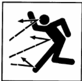
Figura 3.1.e. Las cortadoras de césped frecuentemente tiran objetos.
