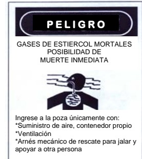
Figura 3.3.1.a. Las señales de seguridad nos previenen de peligros inmediatos. Esta señal nos dice que se necesita protección para respirar. Qué otras prácticas de seguridad nos recomiendan con esta señal?
